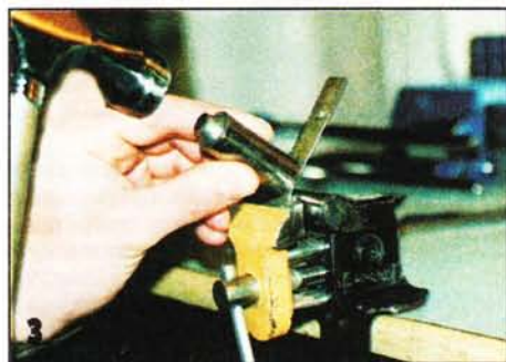
3 Используя обрезки прутков, согнули накладки под профиль боковых поверхностей платформы в зоне разлома.
