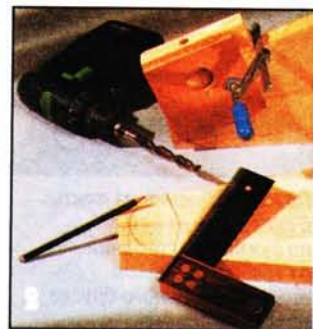
На ступеньках размечают отверстия под стойку и ножки, пользуясь угольником и кондуктором.
