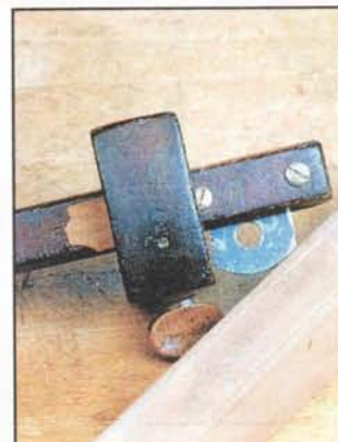
Резак для выборки пазов, параллельных кромкам. Он сделан из старого рейсмуса и обломка полотна лучковой пилы.
