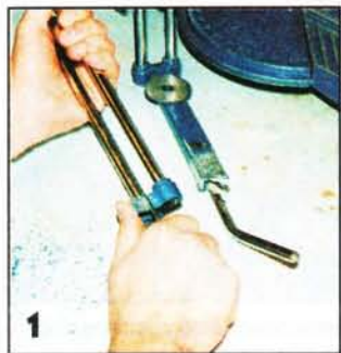
1 Сняв поворотную платформу, счистили шабером краску с поверхностей у разлома.
