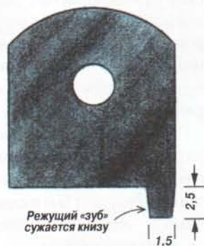
Резак для выборки пазов, параллельных кромкам. Он сделан из старого рейсмуса и обломка полотна лучковой пилы.
