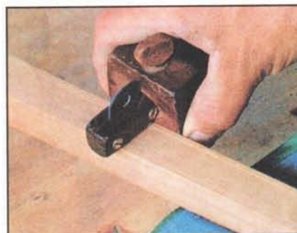
Пазы выбирают лёгкими проходами, наклонив резак. С каждым проходом угол наклона резака должен увеличиваться, пока не достигнет 90°.
