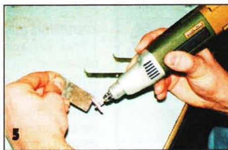
5 С помощью той же бормашинки шлифовальным камнем не только притупили острые кромки, но и точно подогнали накладки к прилегаемым поверхностям платформы.
