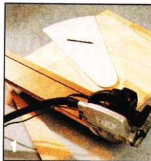
Ступеньки размечают по шаблону, выкроенному из твёрдой ДВП, и вырезают ручной дисковой пилой по направляющей.
